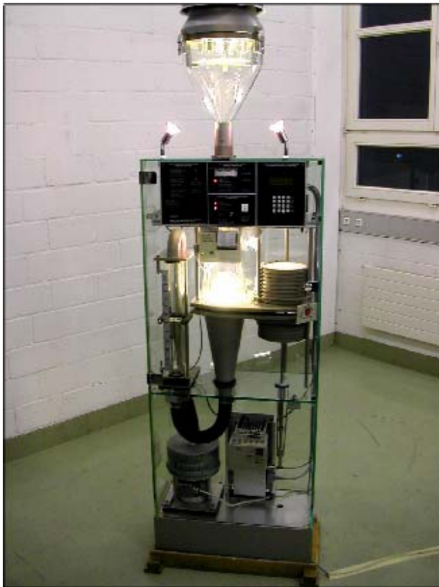
PM10-Staubprobensammler Digitel DA-80H
