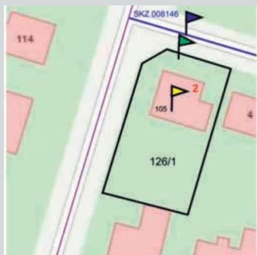
Bild 6: Geocodierung der Adresse – mit automatisch berechneter Zugangs- (grün) und GIP-(blau) Koordinate und unveränderter Geocodierung des Gebäudes (gelb) - Basemap
